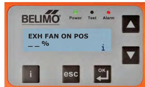
IN THE SETTINGS MENU SCROLL DOWN TO EX FAN ON POS AND SET THE PERCENTAGE OF O/A THE POWER EXHAUST WILL COME ON AT
