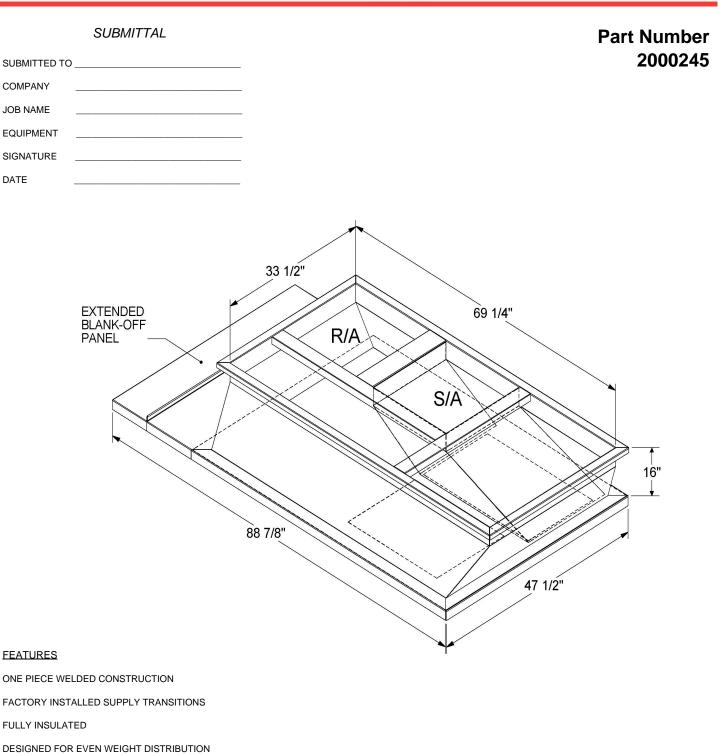
FABRICATED OF HEAVY GAUGE G90 GALVANIZED STEEL
