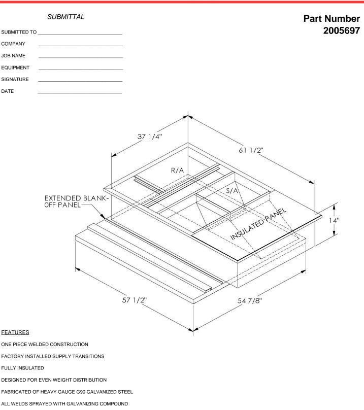
GASKET PROVIDED FOR UNIT TO ADAPTER SEALING
