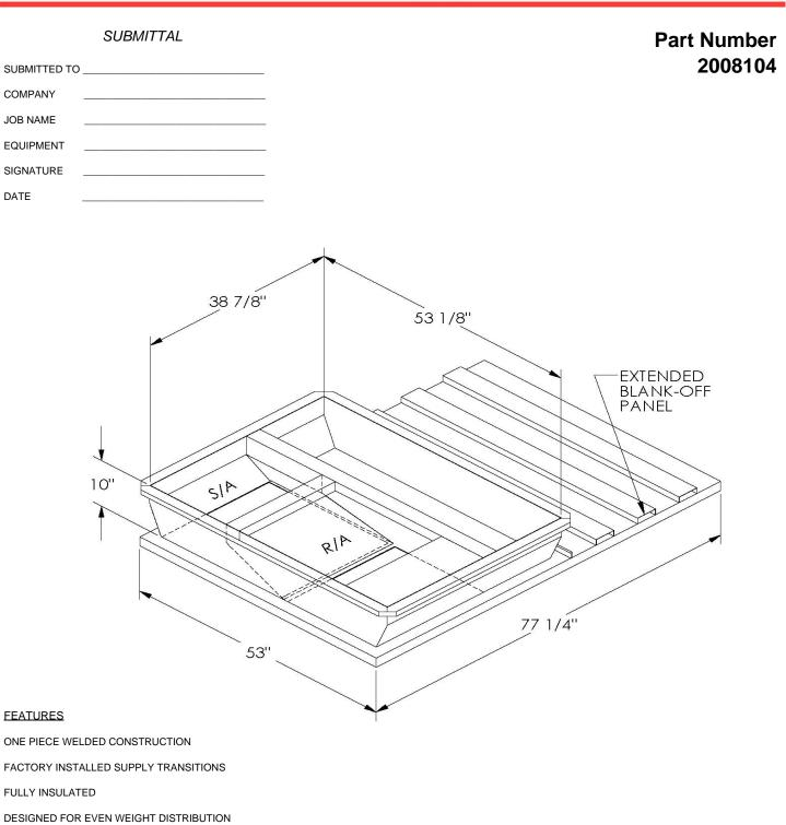
FABRICATED OF HEAVY GAUGE G90 GALVANIZED STEEL
